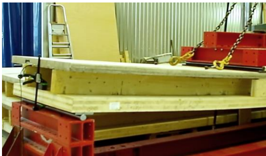
Kompositbjälklag i trä och betong
